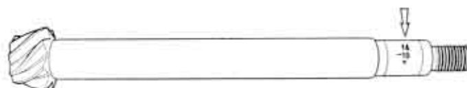
Fig. 17. - Albero secondario con pignone conico.
